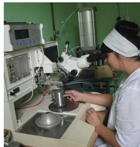
Роботизированная микросварка мостиков накалывания.
